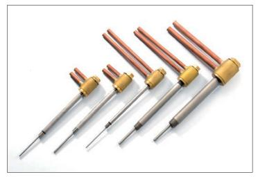
銅パイプの長さはお好きな寸法に指定出来ます。(指定なき場合は約30 mm) 銅パイプは、簡単に自由な方向へ曲げることが可能です。 極細パイプで今まで冷却できなかったピンも冷却 OK! 豊富なパイプサイズでどんなピンも冷却!
